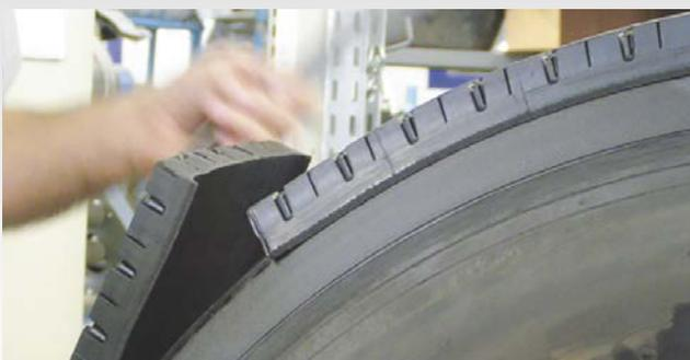
Cette opération consiste à rénover totalement la bande de roulement en conservant la carcasse d'origine, pour produire des pneus conformes à la norme européenne ECE 109.
