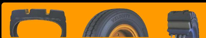
Les structures et profils anti-FOD (Foreign Object Damage) limitent la rétention de corps étrangers dans les sculptures.
